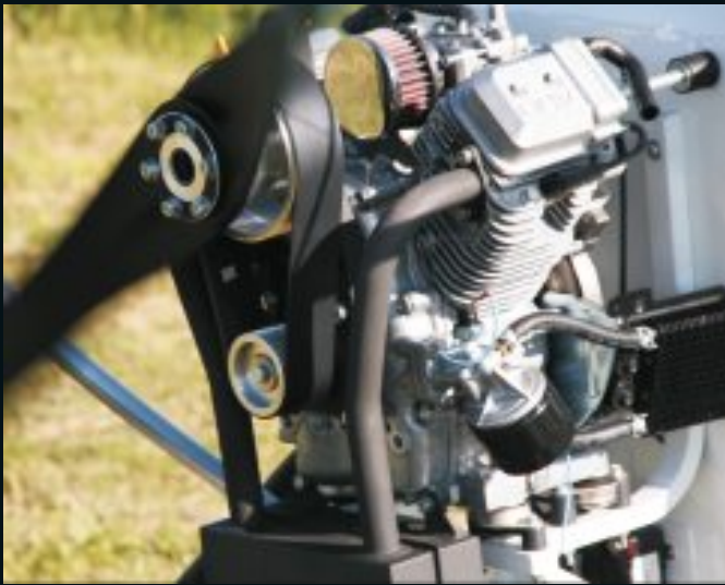
4-temps, bicylindre en V, 32 HP
